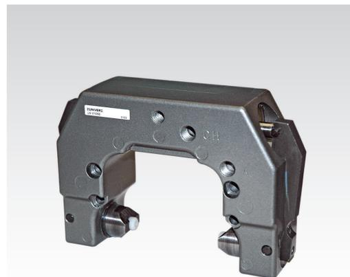
Il blocco di stazionamento UNIVER, per cilindri senza stelo, ha la funzione di trattenere il carrello in qualsiasi punto della sua corsa ed è in grado di soddisfare una buona precisione di bloccaggio. Può essere montato indifferentemente su entrambi i lati del carrello e la sua forza di frenatura meccanica può ulteriormente essere amplificata con un eventuale comando pneumatico aggiuntivo.
