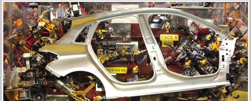
Applicazione di bloccaggi CNOMO
