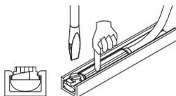
Tenere il sensore in posizione e ruotando con un cacciavite la piastrina di fissaggio, fissarlo saldamente alla cava. Coppia Max: 0,5 ÷ 1 Nm
