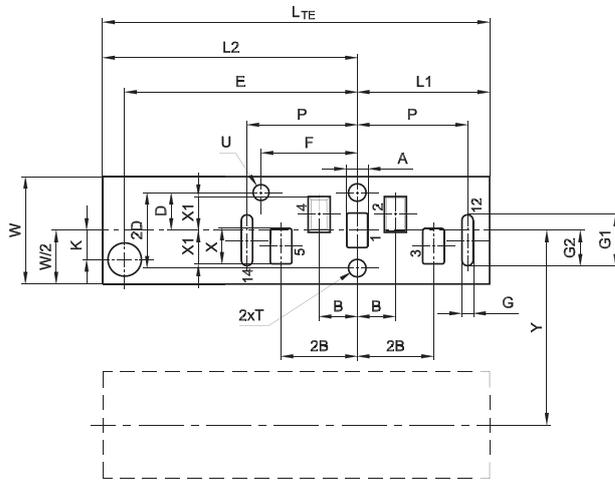
Y = Distanza minima tra gli assi delle interfacce di montaggio in successione della stessa dimensione, su blocco multiplo
