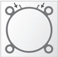
Profilé du tube avec rainures capteurs intégrées
