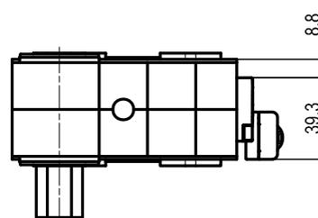
\* : TOLERANCE BETWEEN DOWELS  $\pm 0,02$ , BETWEEN SCREW HOLES  $\pm 0,1$
