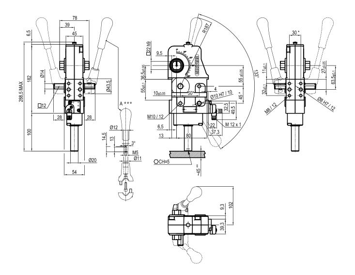
\* : TOLERANCE BETWEEN DOWELS  $\pm$  0,02, BETWEEN SCREW HOLES  $\pm$  0,1
