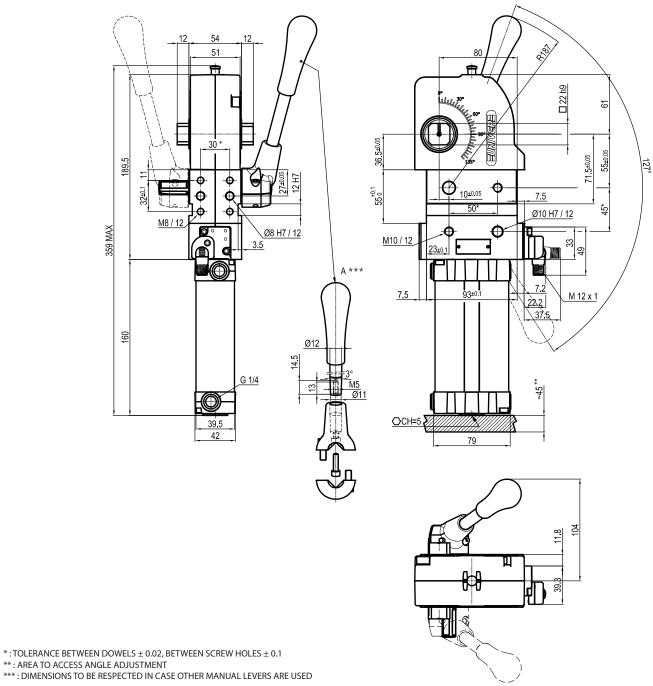
\* : TOLERANCE BETWEEN DOWELS  $\pm$  0.02, BETWEEN SCREW HOLES  $\pm$  0.1
