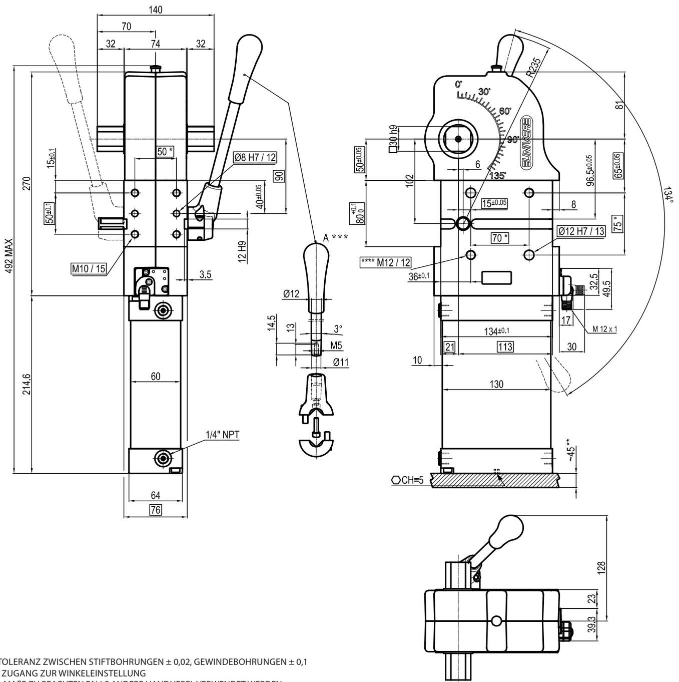
\* : TOLERANZ ZWISCHEN STIFTBOHRUNGEN  $\pm 0,02$ , GEWINDEBOHRUNGEN  $\pm 0,1$
