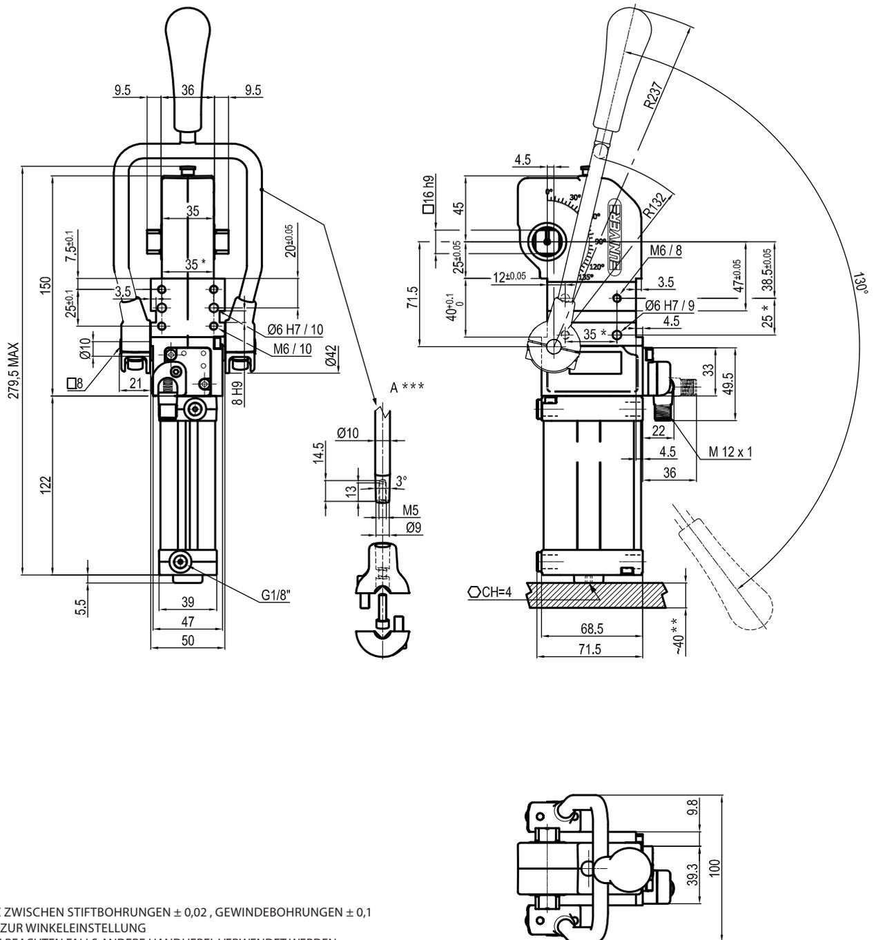
\* : TOLERANZ ZWISCHEN STIFTBOHRUNGEN  $\pm 0,02$  , GEWINDEBOHRUNGEN  $\pm 0,1$
