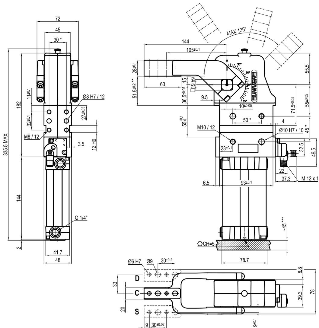
\* : TOLERANZ ZWISCHEN STIFTBOHRUNGEN ± 0,02 , GEWINDEBOHRUNGEN ± 0,1
