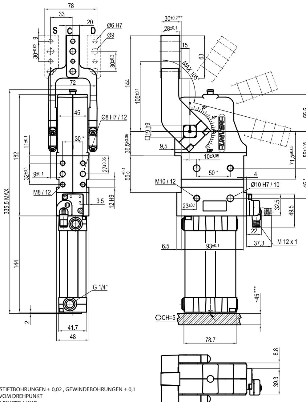
\* : TOLERANZ ZWISCHEN STIFTBOHRUNGEN  $\pm 0,02$  , GEWINDEBOHRUNGEN  $\pm 0,1$
