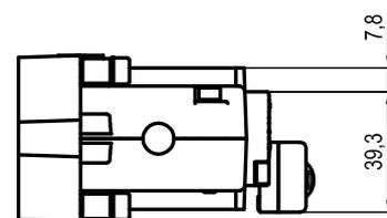
\* : TOLERANZ ZWISCHEN STIFTBOHRUNGEN  $\pm 0,02$  , GEWINDEBOHRUNGEN  $\pm 0,1$
