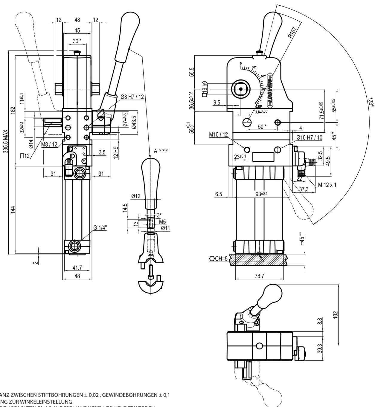
\* : TOLERANZ ZWISCHEN STIFTBOHRUNGEN ± 0,02 , GEWINDEBOHRUNGEN ± 0,1
