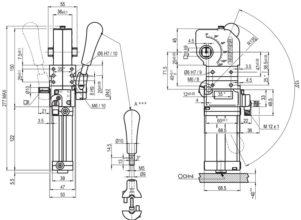
\* : TOLERANZ ZWISCHEN STIFTBOHRUNGEN  $\pm 0,02$  , GEWINDEBOHRUNGEN  $\pm 0,1$
