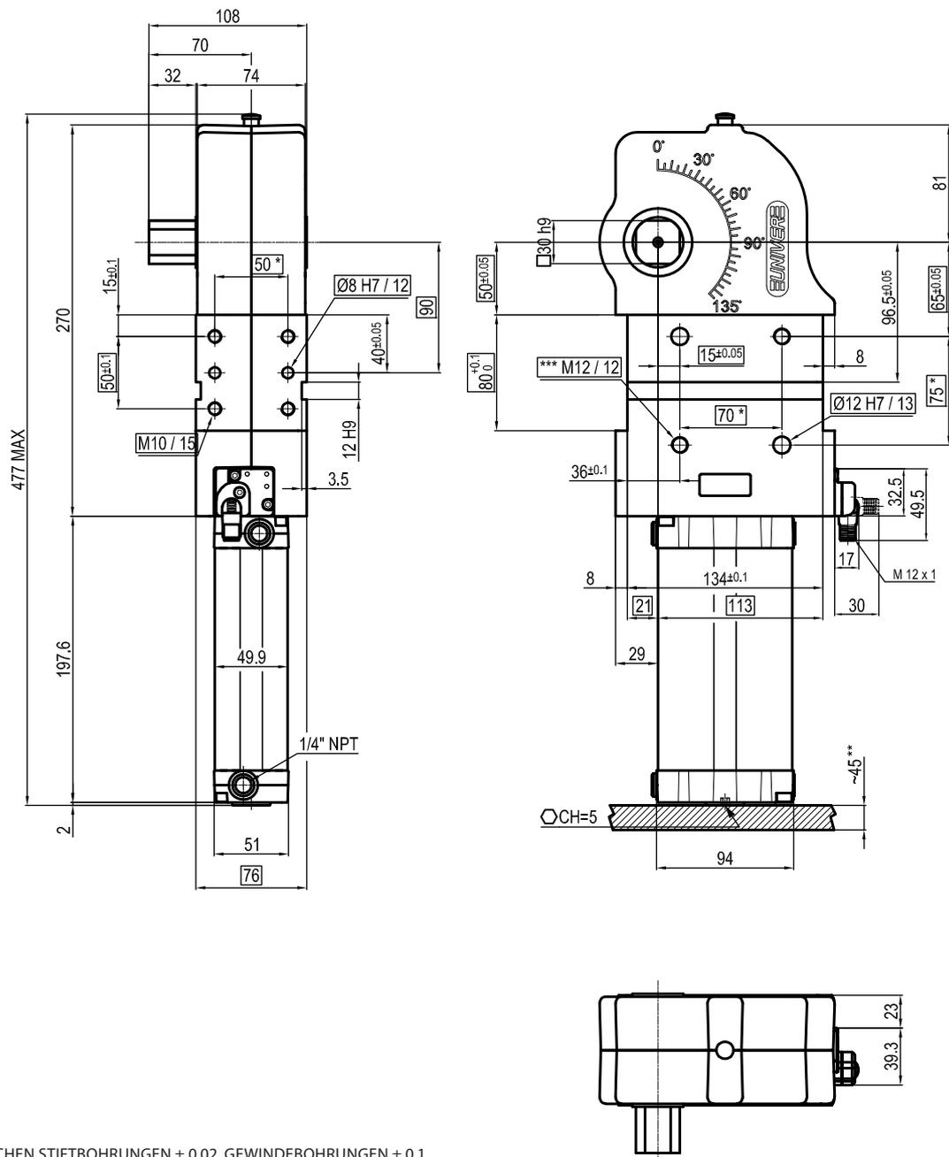
\* : TOLERANZ ZWISCHEN STIFTBOHRUNGEN ± 0,02, GEWINDEBOHRUNGEN ± 0,1
