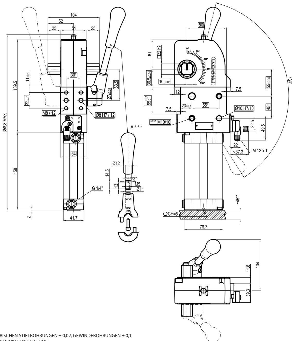
\* : TOLERANZ ZWISCHEN STIFTBOHRUNGEN ± 0,02, GEWINDEBOHRUNGEN ± 0,1
