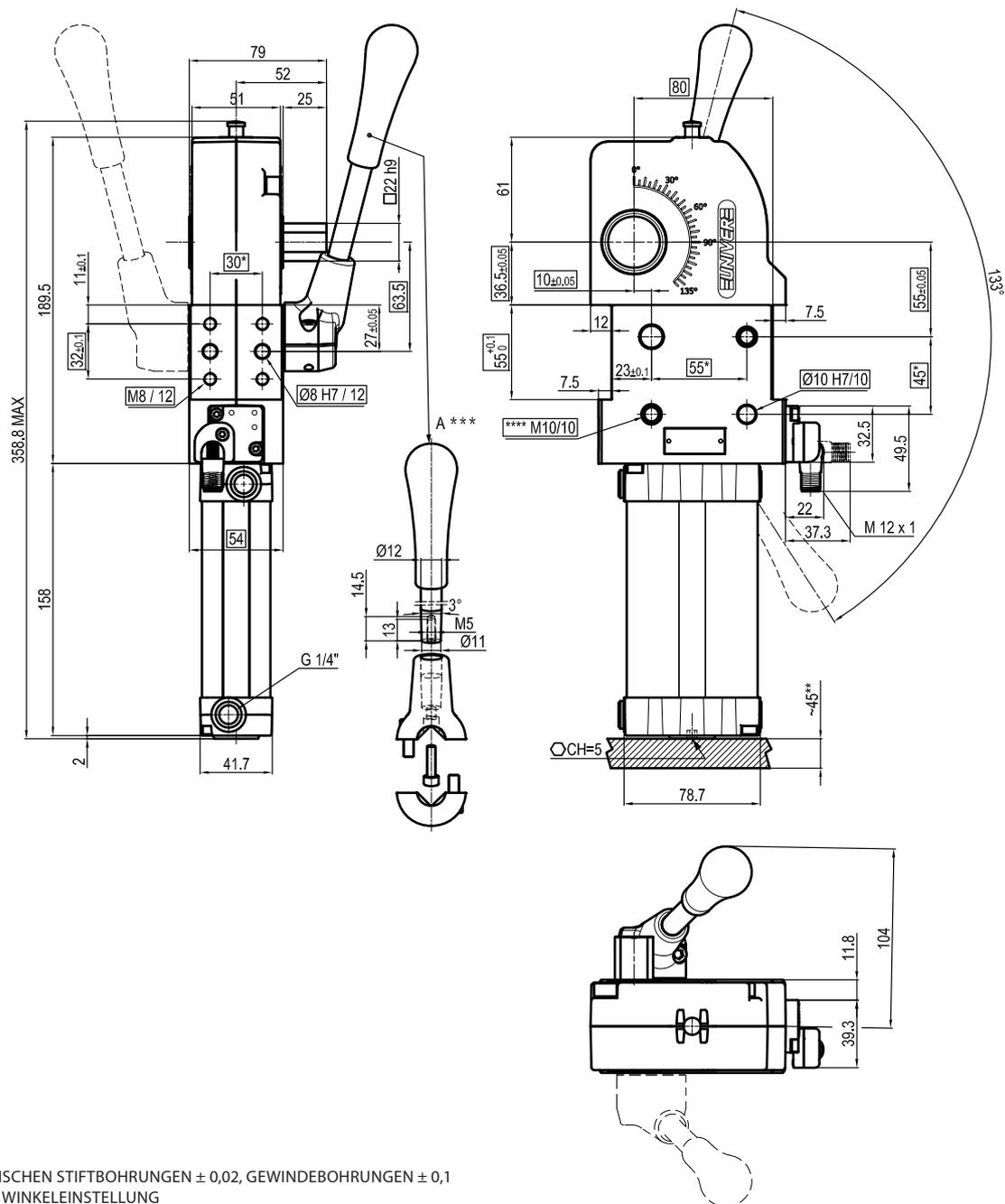
\* : TOLERANZ ZWISCHEN STIFTBOHRUNGEN  $\pm 0,02$ , GEWINDEBOHRUNGEN  $\pm 0,1$
