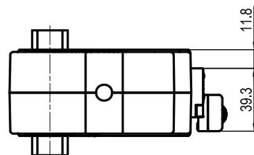
\* : TOLERANZ ZWISCHEN STIFTBOHRUNGEN  $\pm 0,02$  , GEWINDEBOHRUNGEN  $\pm 0,1$
