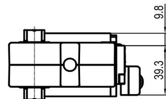
\*: TOLERANZ ZWISCHEN STIFTBOHRUNGEN ± 0,02 , GEWINDEBOHRUNGEN ± 0,1
