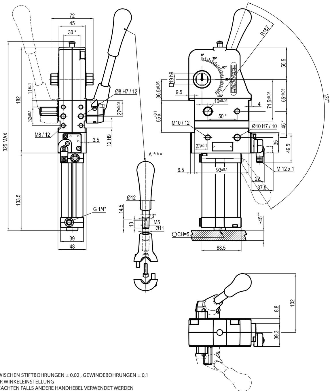
\* : TOLERANZ ZWISCHEN STIFTBOHRUNGEN  $\pm 0,02$  , GEWINDEBOHRUNGEN  $\pm 0,1$
