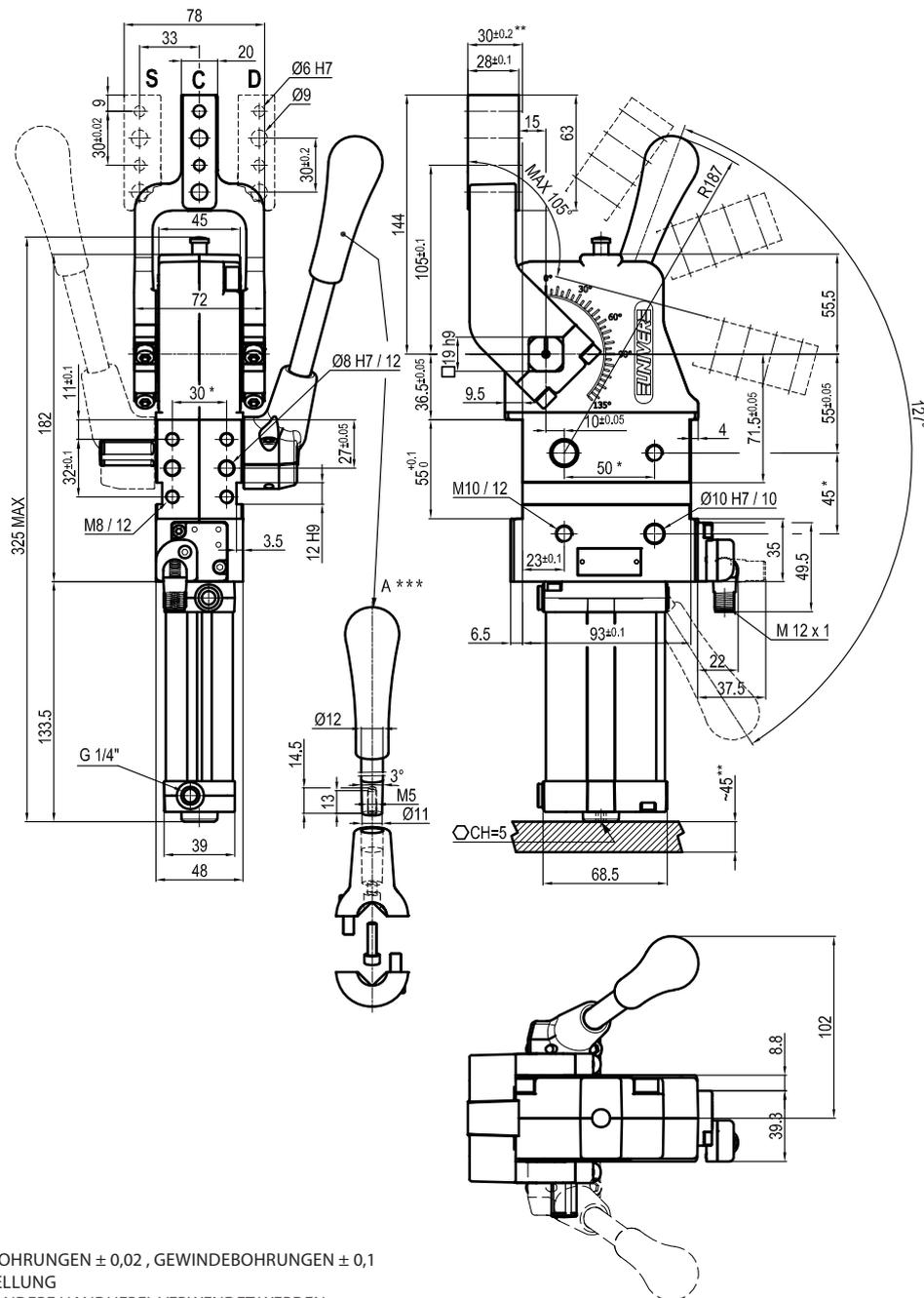
\* : TOLERANZ ZWISCHEN STIFTBOHRUNGEN  $\pm 0,02$ , GEWINDEBOHRUNGEN  $\pm 0,1$
