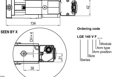
\*: TOLERANCE FOR DOWEL HOLES ± 0.02 FOR SCREW HOLES ± 0.1
