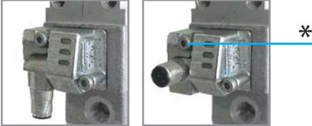
1. Svitare la vite di fissaggio indicata (\*)
